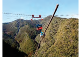
遠隔操作が可能な架線式グラブと油圧集材機による「新たな架線集材システム」を開発
